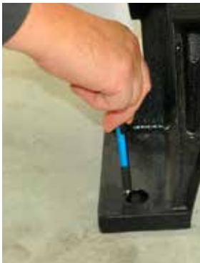
Εικόνα 8a: Σήμανση των οπών
