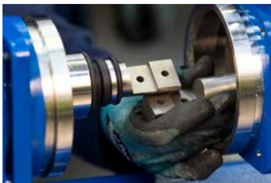
6. Отсоедините гидравлический ротор от приводного вала.
