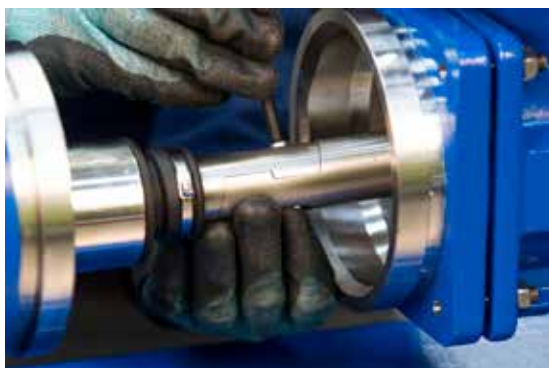
5. Разъем муфты соединяется вместе с помощью винтов.
