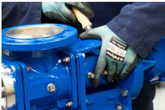
1. Демонтируйте статор и ротор, обеспечьте доступ к приводу.
