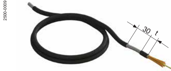
Рис. 25 Перед подключением к клеммной колодке следует зачистить 30 мм от кабеля EMC. Расстояние «t» соответствует приблизительно зазору между крепежным зажимом и наконечником кабеля
